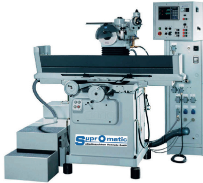
Bild 1: Generalüberholte JUNG HF 50 mit modernisierter Steuerung
